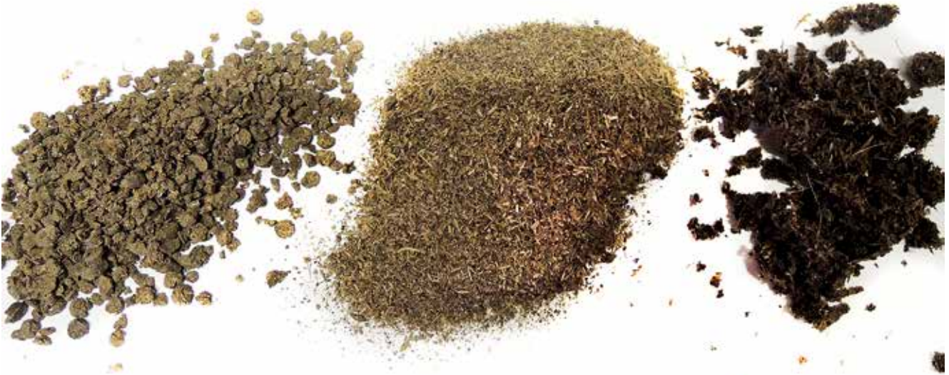
↗ Sian lietelannasta on maatilalla erotettu kuivajae separoimalla (oikealla). Kuivatusta on jatkettu lannoitetehtaalla (keskellä) ja lopuksi kuiva jae on puristettu lannoiterakeiksi (vasemmalla).
